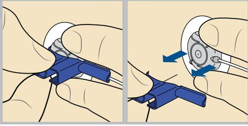
按住输注管路,直着向外拉蓝色手柄,将针取下。
