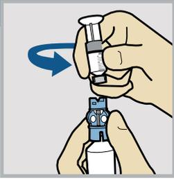
为避免胰岛素洒落在储药器顶部,再次翻转药瓶以使储药器在上。捏住移液罩,逆时针旋转储药器,从移液罩上取下储药器。
