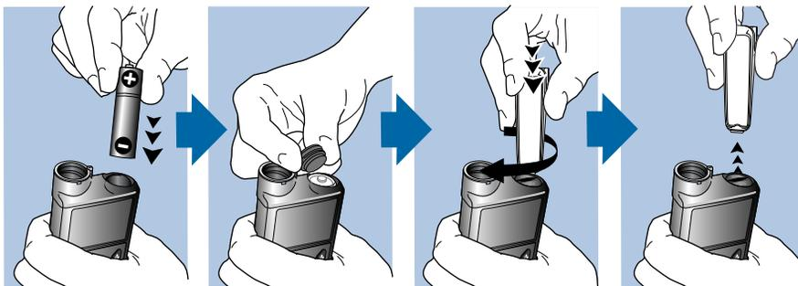
2. Coloque la tapa del portapilas en la bomba. Utilice el borde inferior del clip o una moneda para apretar la tapa.
