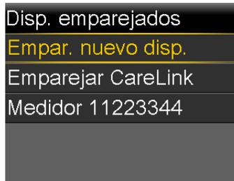
2. Seleccione el número de serie del medidor para desemparejar el dispositivo. El número de serie del medidor Accu-Chek™\* Guide Link se encuentra en la parte posterior del propio medidor.
