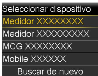
Si se realiza correctamente la conexión, aparece en la bomba el mensaje "Emparejamiento realizado con éxito". En la pantalla del medidor aparece el mensaje "Emparejado con bomba" junto con el número de serie de la bomba. Si aparece la alerta Dispositivo no encontrado, consulte *Alarmas, alertas y mensajes de la bomba, página 305* para obtener más información.
