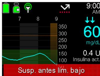
La infusión de insulina basal se reanuda automáticamente cuando se cumplen ciertas condiciones. La infusión basal se puede reanudar manualmente en cualquier momento.
