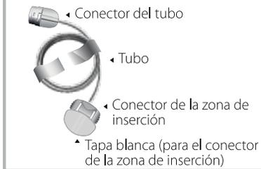
Extraiga el tubo del equipo de infusión del paquete. Retire el papel que mantiene unido el tubo y desenróllelo.
