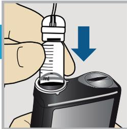
Coloque el reservorio en la bomba. **No** conecte el equipo de infusión al cuerpo.
