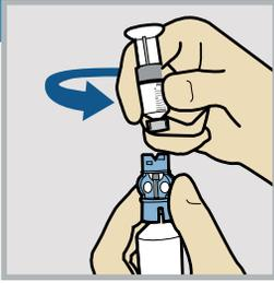
Para evitar que entre insulina en la parte superior del reservorio, **vuelva a dar la vuelta al vial para que el reservorio quede arriba.** Sujete el protector de transferencia, y gire el reservorio hacia la izquierda y extráigalo del protector de transferencia.
