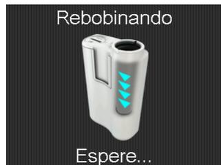
Con el tubo del equipo de infusión extraído del cuerpo y el reservorio retirado de la bomba, seleccione **Rebobinar**.
