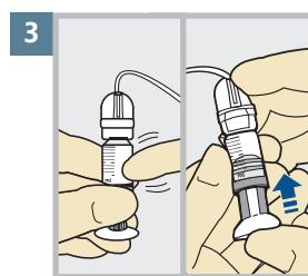
如果您看到气泡，弹储药器使它们移到顶端。将柱塞推一点点，使它们进入管路。
