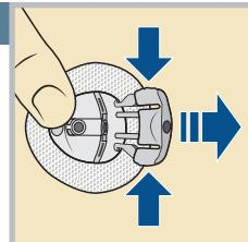
用手指轻轻按住套管罩。然后捏住断路护盖的两侧并将其从套管罩中拔出。
