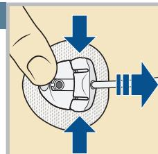
若要断开连接，请用手指轻轻按住套管罩。然后捏住植入部位连接器的两侧并将其从套管罩中拔出。
